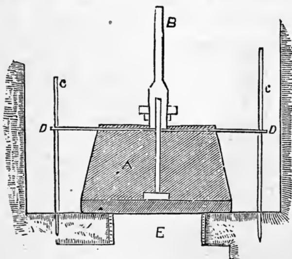
Fig. 116.—DISCHARGING PLUNGER VALVE.
