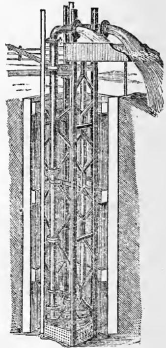
Fig. 106.—METHOD OF OPERATING A CENTRIFUGAL PUMP.
