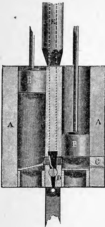
Fig. 5.—DOUBLE-ACTING FORCE PUMP.
