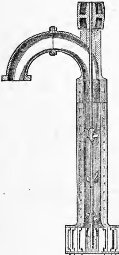
Fig. 105.—CENTRIFUGAL PUMP.
