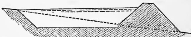
Fig. 118.—RESERVOIR ON SLOPING GROUND.
