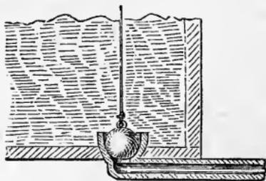
Fig. 33.—VALVE FOR DISTRIBUTING TANK.
