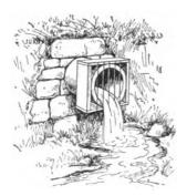
WATER ISSUING FROM AN UNDERGROUND DRAIN.<sup>1</sup>
