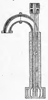
Fig. 105.—CENTRIFUGAL PUMP.
