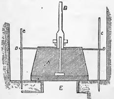
Fig. 116.—DISCHARGING PLUNGER VALVE.
