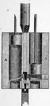
Fig. 5.—DOUBLE-ACTING FORCE PUMP.
